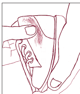
Un contrefort ferme prolongé en cambrure
